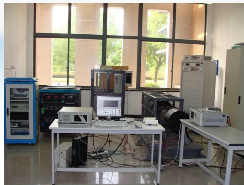
城市轨道交通车辆制动 能量回收实验系统
