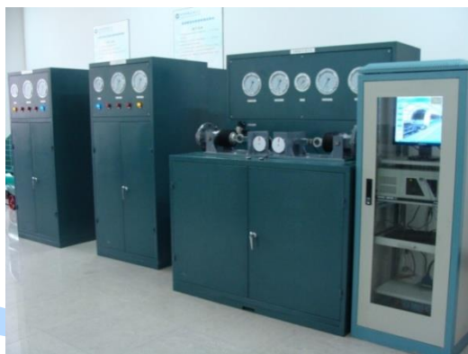
城市轨道交通车辆 空气制动系统实验平台
