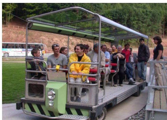
图 3： Simserhof 娱乐公园. Cybercars 采用埋装的感应线.
