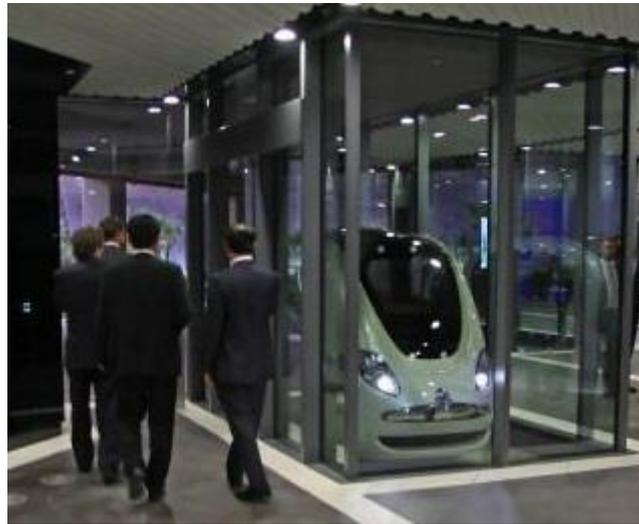
Le même type de système fonctionne aussi à Heathrow Terminal 5 depuis 2010. Il assure la liaison entre un terminal et un parking. Il est prévu d'assurer les liaisons entre tous les terminaux, voire même les hôtels en utilisant ce système. Le taux de disponibilité du système est de 99,8%.
