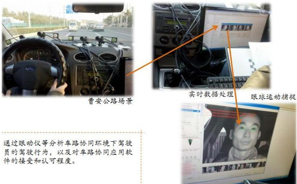
Figure 11 l'analyse des réactions du chauffeur dans le contexte du système du véhicule connecté (application sécurité)
