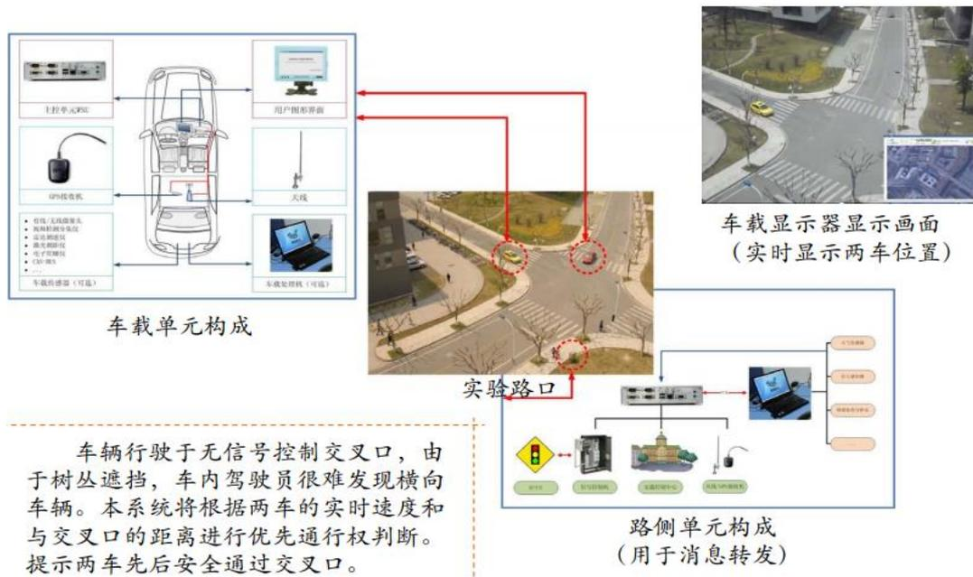
Figure 8 : l'évitement de la collision dans le carrefour (application sécurité)
