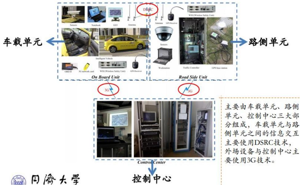
主要由车载单元、路侧单元、控制中心三大部分组成，车载单元与路侧单元之间的信息交互主要使用DSRC技术，外场设备与控制中心主要使用3G技术。
