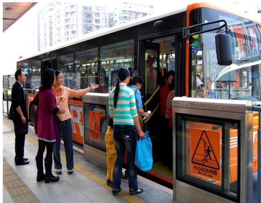
□ BRT车辆安装有射频卡，安全门装有感应接收装置，由司机控制，实现车辆与安全门的联动。
