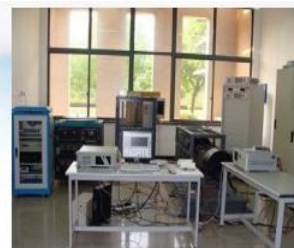
城市轨道交通车辆制动 能量回收实验系统
