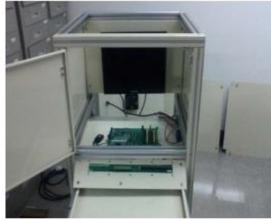
Figure 8 le principe de l'équipement à la détection des pannes du régulateur de climatisation du métro et l'équipement à l'étude
