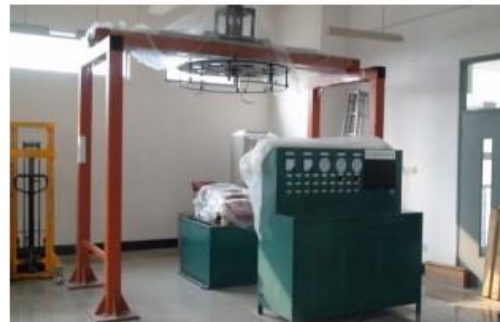
城市轨道交通车辆受电弓综合试验台
