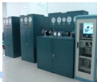
城市轨道交通车辆 空气制动系统实验平台
