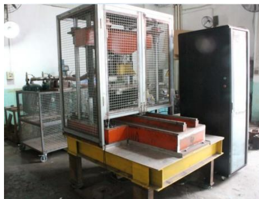
Figure 9 la plate-forme de test à la détection du système de sortie d'air du metro et l'équipement de test
